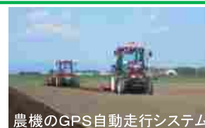
農機のGPS自動走行システム
